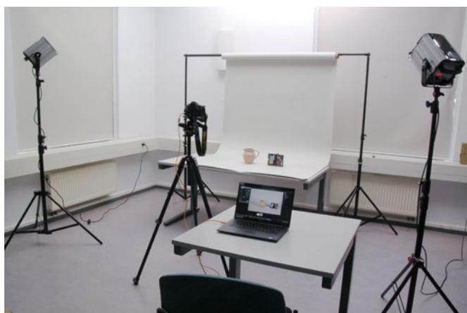
*Fotoarbeitsplatz mit indirekter Beleuchtung des Objekts*
