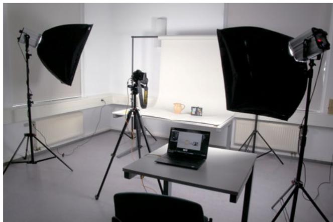
*Fotoarbeitsplatz mit direkter Beleuchtung des Objekts*
